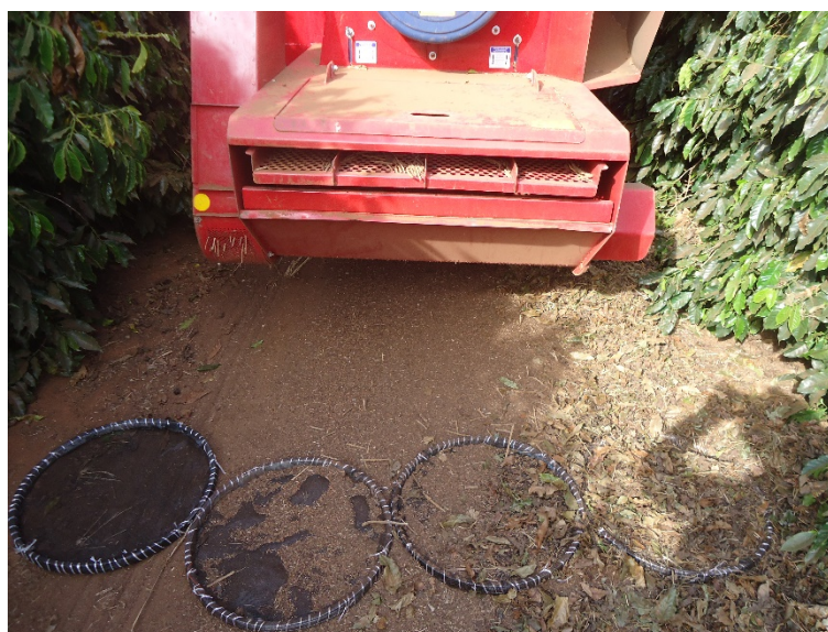
Figura 1. Método de amostragem de perdas na operação de recolhimento mecanizado de café.
